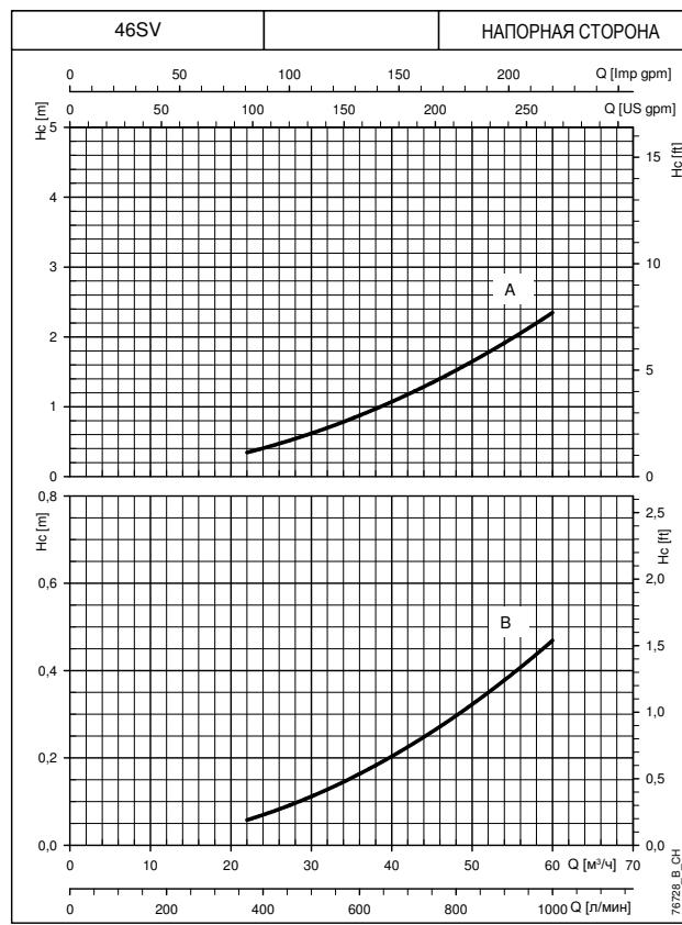
Характеристики приведены для жидкостей с плотностью  $\rho = 1.0 \text{ кг}/\text{дм}^3$  и кинематической вязкостью  $v = 1 \text{ мм}^2/\text{сек}$ .
