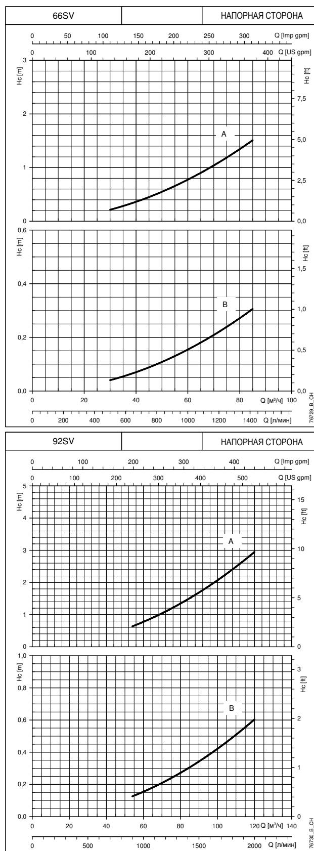
Характеристики приведены для жидкостей с плотностью  $\rho = 1,0 \text{ кг}/\text{дм}^3$  и кинематической вязкостью  $v = 1 \text{ мм}^2/\text{сек}$ .
