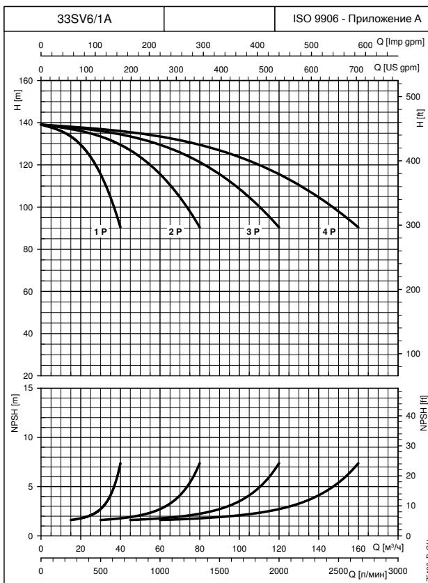
При построении характеристик не учитывались гидравлические потери в клапанах и трубопроводах.
