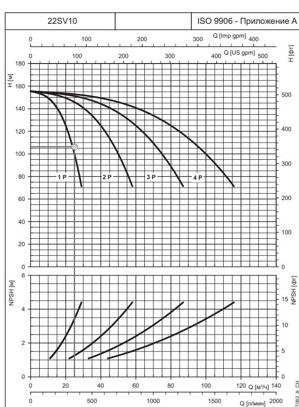
В приведённом рядом примере в качестве исходных берутся расход  $22 \text{ м}^3/\text{ч}$  и давление  $110 \text{ м вод. ст.}$
