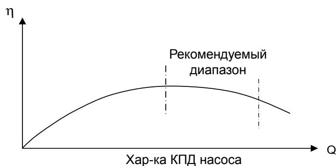
На следующем графике показан оптимальный диапазон для выбора насоса на основании его рабочей характеристики.
